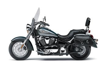
Motor de 4 tiempos, bicilíndrico en V de 55 grados, Motor refrigeración líquida
